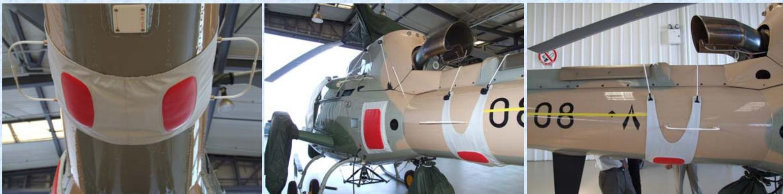
Les obturateurs de filtres des aérations de clim se pose de la même manière, les sandows passent sur la partie supérieure de la poutre.
