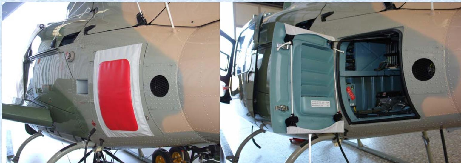
Le protège filtre de la porte soute se fixe simplement sur la portière elle-même grâce à deux petits sandows et crochets, cela permet de l'ouvrir sans retirer l'obturateur.
