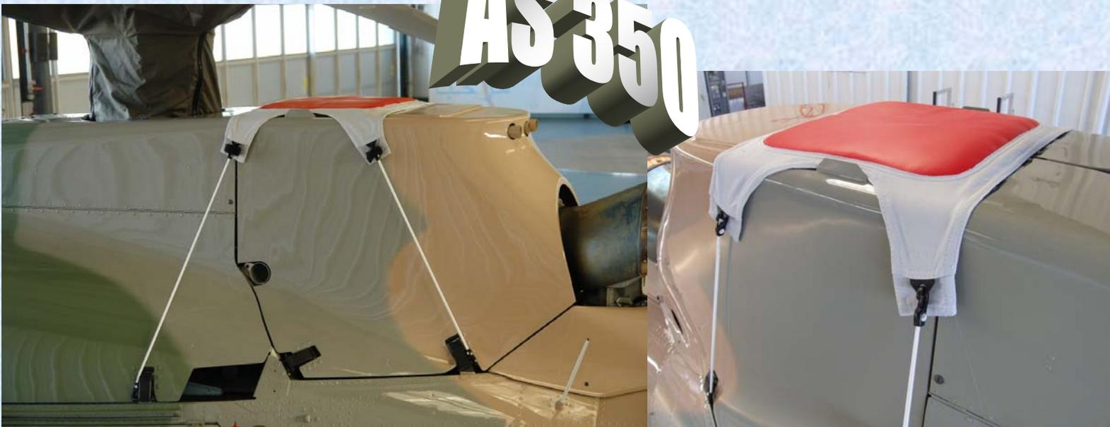
Les obturateurs de filtres anti-sables sont fait dans le tissu Selection pour ne pas rayer, un coussin tampon central moule et comprime la sortie pour éviter au maximum le sable de pénétrer.
