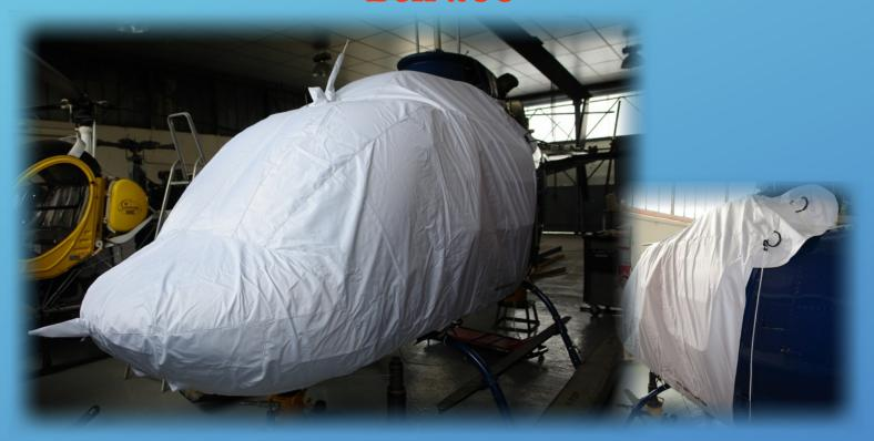
Facile a poser la bâche du Bell couvre de tout l'avant de la cellule jusqu'à la fin des fenêtres arrières, la toile monte jusqu'au pied de la colonne pour limiter les voies d'eau sur les parties latérales.
