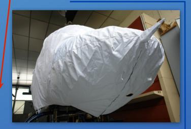
Die einfach aufzulegende Abdeckplane des Bell 206, bedeckt den ganzen vorderen Teil der Zelle bis ans Ende der hinteren Fenster. Die Plane geht hoch bis zum
