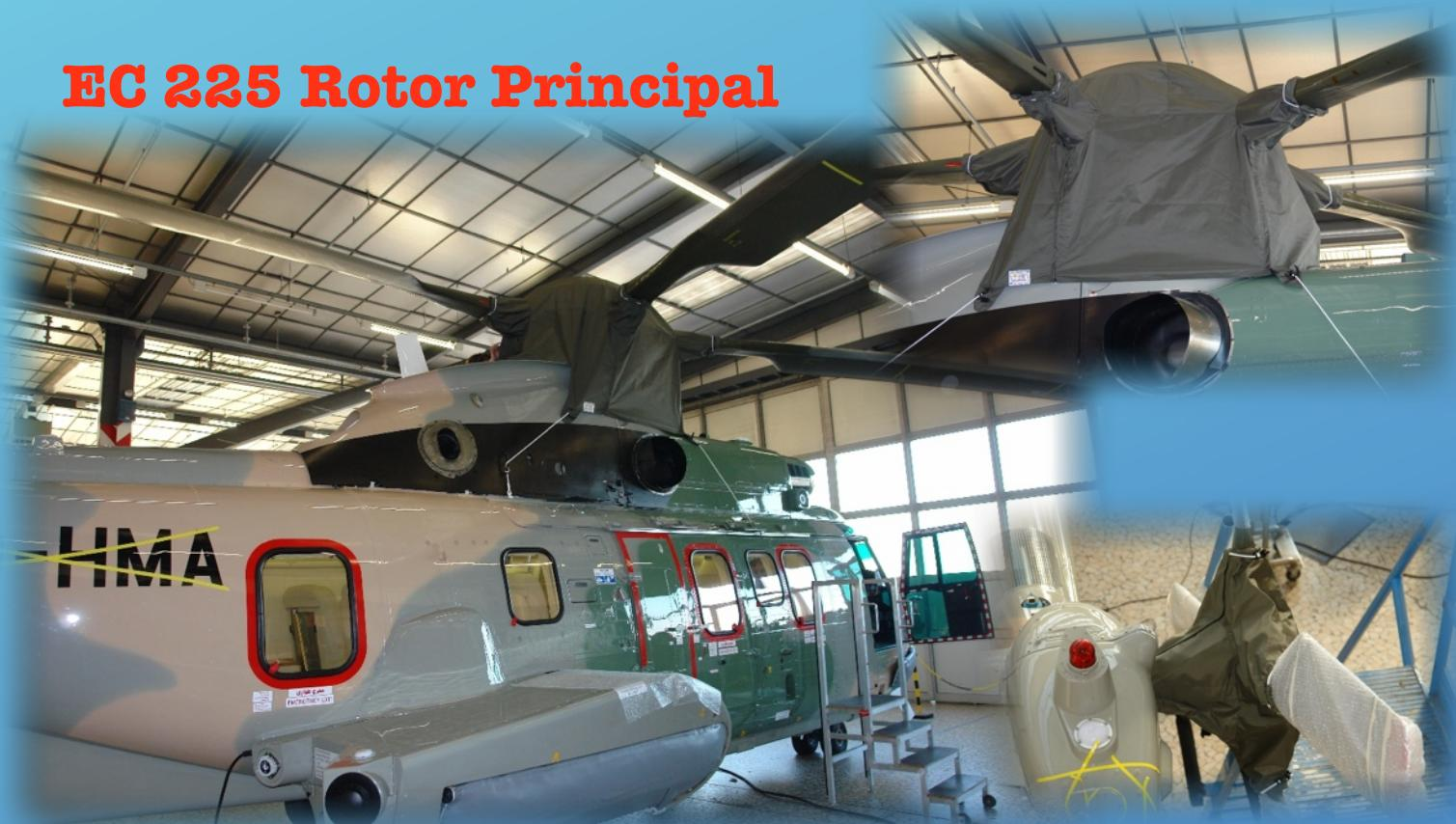
Facile à poser la housse de rotor principal se referme sur elle-même grâce à trois larges fermetures Eclair en plastique pour permettre de fonctionner en région sableuse, des bavettes internes et externes protègent des rayures et UV.
