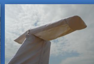
La poutre se fixe par trois Velcro sur la housse de cellule, nous l'avons faite amovible pour une pratique de pose, éviter qu'elle ne traîne à terre et quelle se salisse.
