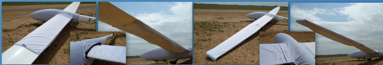
Pour une pose plus pratique les ailes sont souvent faites en deux ou trois parties, cela permet aussi dans certains cas de couvrir le planeur quand une partie de l'aile est démontée.
