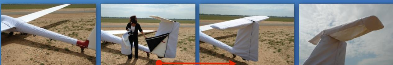
La poutre se fixe par trois Velcro sur la housse de cellule, nous l'avons faite amovible pour une pratique de pose, éviter qu'elle ne traîne à terre et quelle se salisse.
