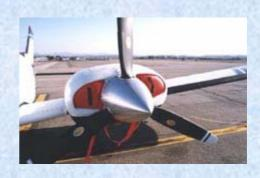
Les caches aérateurs permettent une étanchéité totale des entrées d'air.
