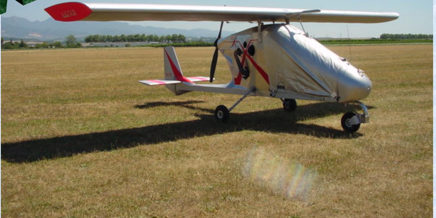
Facile à poser cette housse a besoin de 4 fixations, deux sandows passe par-dessous, et une par cotés sur la partie haute.
