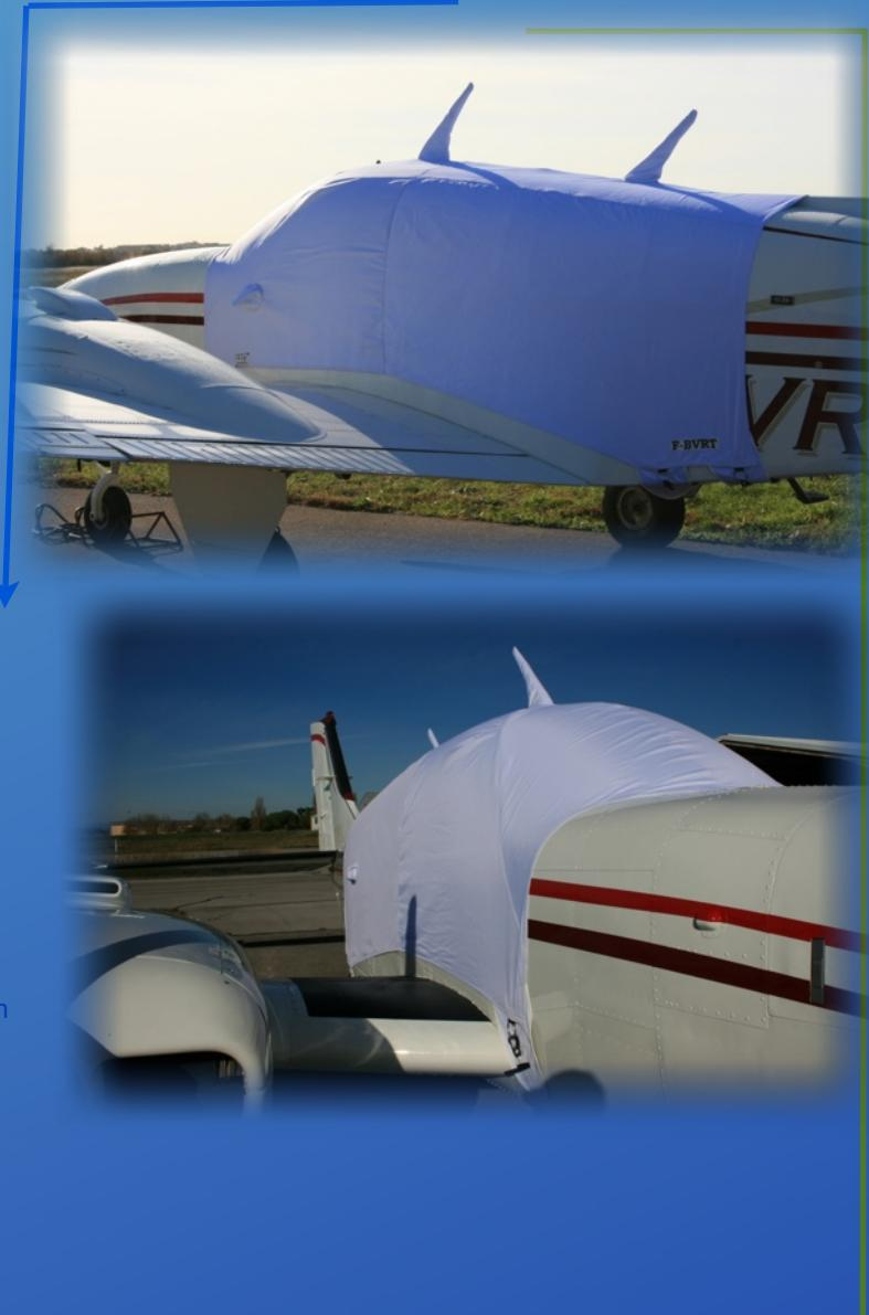
Sono necessari tre fissaggi per posizionare la copertura del «**Baron**» una anteriori la blocca davanti al parabrezza,
