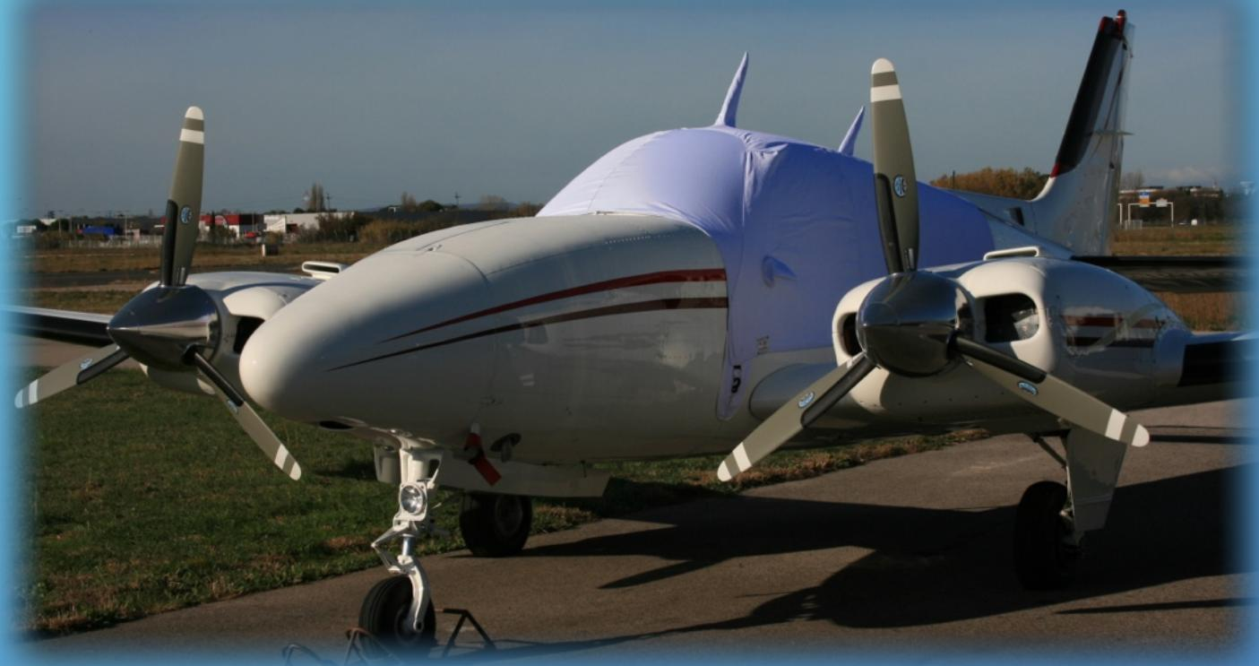
Trois fixations sont nécessaires pour poser la bâche de cellule du «Baron» une a l'avant la plaque devant le pare brise, deux autres la maintiennent tirée vers l'arrière.
