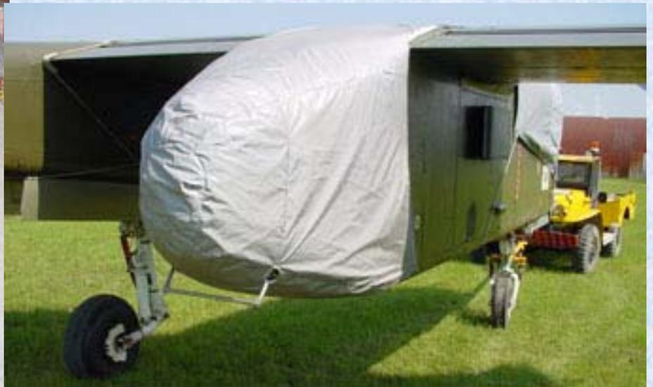
Un velcro sur la partie supérieure permet l'assemblage des deux bâches qui peuvent quand même être posées séparément .
