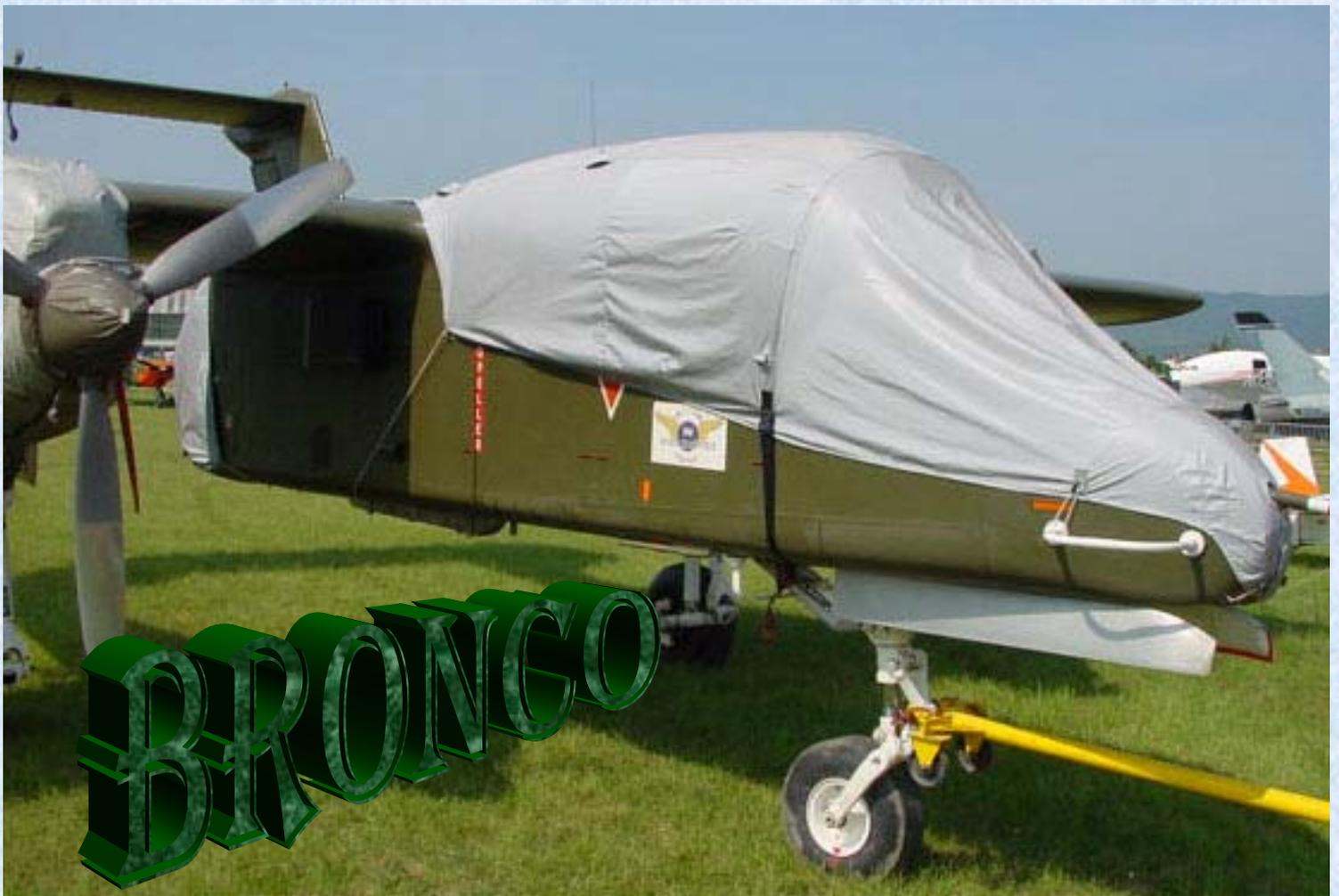
Un très bon exemple de modèle «ISOLUXE » la bâche du BRONCO s'enfile par l'avant, des fixations la maintiennent par-dessous , et la toile continue dessus , se fixe sur les bords de fuite ou se joint à la housse de la bulle par un velcro. Les poignées sont recouvertes par des bonnets ce qui permet de les attraper.
