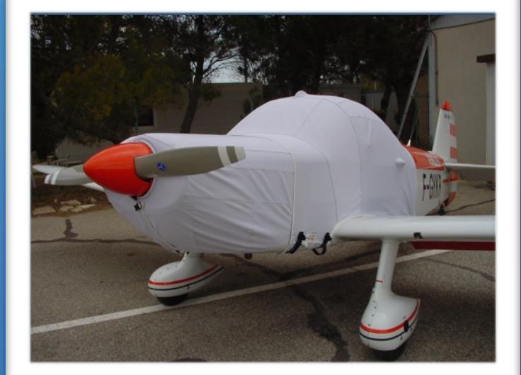
Die Motorhauben-abdeckung (separat-Verkauf) befestigt man mit seinen 3 Velcros auf der Kabinenabdeckhaube und verschliesst sie unter der Maschine mit einem Velcro-Verschluss und 2 Clipsen.
