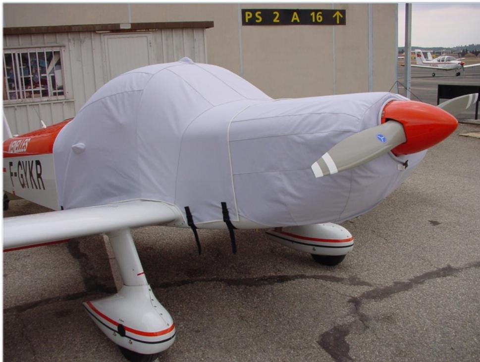
Quatre fixations sont nécessaires pour poser la bâche Verrière longue du «cap 10» deux a l'avant la plaquent devant le pare brise, deux autres la maintiennent tirée vers l'arrière.
