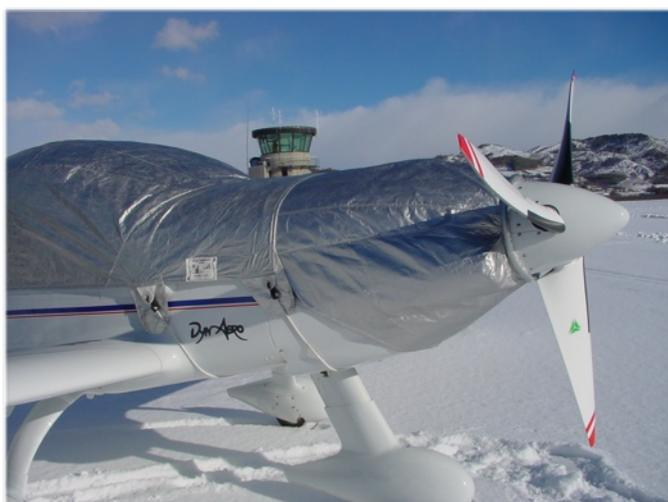
Vendue en option la bâche capot moteur se pose grâce à ses trois Velcro sur la partie avant et se referme dessous par un autre Velcro et deux boucles à clips, un fourreau contourne le cône d'hélice avec un Sandow et deux crochets plastiques, ainsi couvert l'avant de la cellule est hors d'eau et poussière jusqu'à la base du cône, d'autres éléments amovibles peuvent s'ajouter pour couvrir l'avion entièrement.
