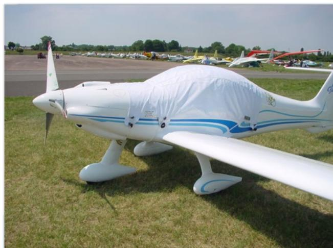
Trois fixations sont nécessaires pour poser la bâche du MCR, deux à l'avant la plaquent devant le pare-brise, et une autre la maintient tirée vers l'arrière, ainsi moulée le vent ne peut s'engouffrer et faire danser la toile, les bonnets qui recouvrent les poignées permettent un ajustage parfait.
