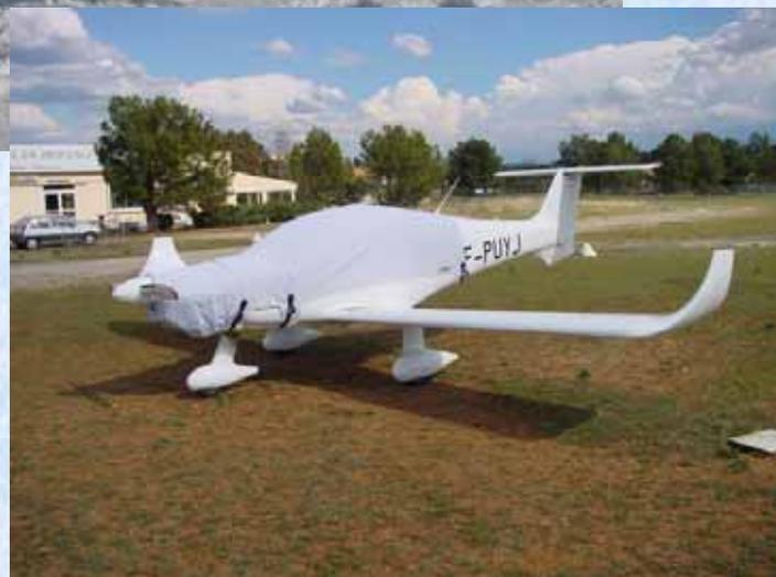
Trois fixations suffisent pour poser la housse du 4 S , ainsi couvert tout les risques de voies d'eau sont écartés, cloison pare-feu verrière et soute sont ainsi étanche, à l'eau et aux UV.
