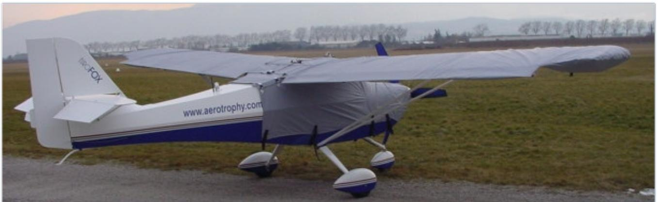
Les housses peuvent être posé indépendamment de la housse de verrière, Toutefois elles donnent la possibilité d'être posée ailes Rabattue, grâce a une découpe Velcro, il est même possible de dégager la partie supérieure de la housse de cellule, et de la reposer par dessus en la maintenant fixé avec des Sandows, ce qui permet d'avoir la cellule a l'Abris une fois les ailes en position repliées.
