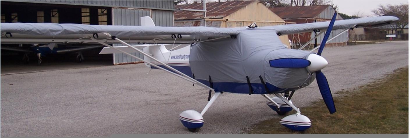
Les housses d'ailes de l'Eurofox s'enfilent de part et d'autres par les Saumons, un fourreau les maintiennent bloqués en bous d'ailes.
