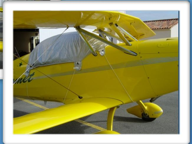
Trois fixations sont nécessaires pour poser la bâche du FK12, deux à l'avant la plaquent devant le pare brise, et une autre la maintient tirée vers l'arrière, ainsi moulée le vent ne peut s'engouffrer et faire danser la toile, les bonnets qui recouvrent les poignées permettent un ajustage parfait.
