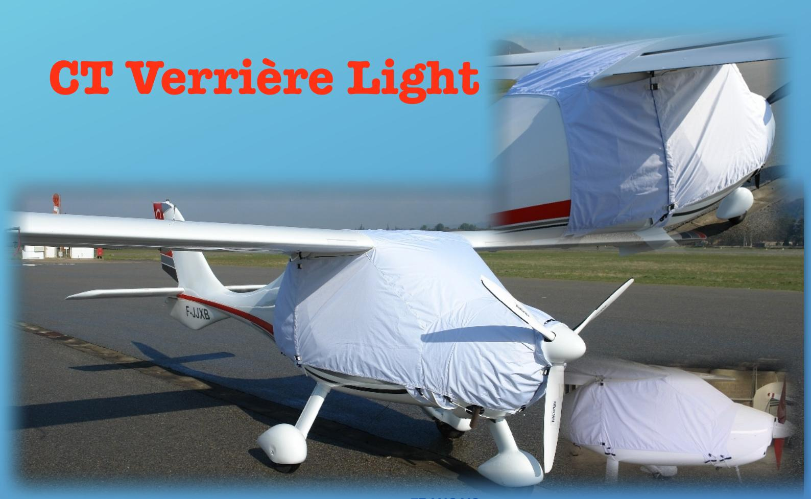
Quatre fixations sont nécessaires pour poser la bâche de verrière light du «CT» deux a l'avant la plaquent devant le pare brise, deux autres la maintiennent tirée vers l'arrière.
