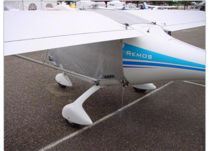
Cinq fixations sont nécessaires pour poser la bâche du G3, deux à l'avant la plaquent devant le pare brise, deux autres la maintiennent tirée vers l'arrière.
