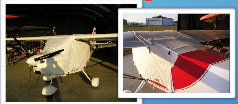
Sept fixations sont nécessaires pour poser la bâche du Super Guepard, deux a l'avant la plaquent devant le pare brise, deux autres la maintiennent tirée vers l'arrière, et deux partent des bords d'attaques jusqu'aux bords de fuites, maintenant la partie supérieure de la cellule avec les départs d'ailes en place.
