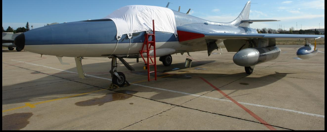
Réalisé dans le tissu ecolight, 6 fixations sont nécessaires pour poser la bâche du HUNTER. Deux à l'avant la maintiennent plaqué sur le nez de l'appareil, deux à l'arrière la maintiennent en place, et deux sur les parties supérieures arrières viennent se prendre sur le karman de l'aile à l'aide de deux crochets plats. Rangée dans son sac fourni, la bâche légère, ne prend que très peu de place dans l'avion, et peu s'emporter partout.
