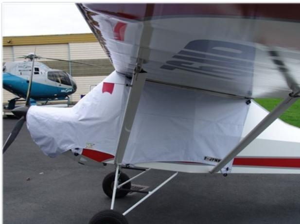
Sur le J 300 la bâche capot moteur est cousu sur la partie avant et se referme dessous par un autre Velcro plus deux boucles a clips, un fourreau contourne le cône d'hélice avec un Sandow et deux crochets plastiques.
