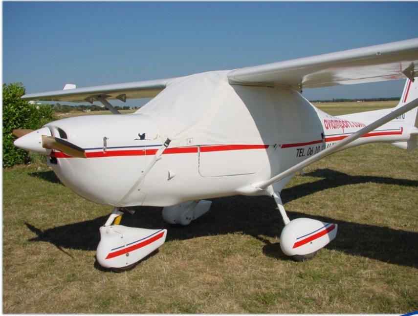
Trois fixations sont nécessaires pour poser la bâche de cellule du Jabiru deux a l'avant la plaquent devant le pare brise, une autre la maintient tirée vers l'arrière, Ainsi moulée le vent ne peut s'engouffrer et faire danser la toile, cette housse totale permet de protéger la cellule des UV, de la pluie, des rayures et des indiscretions .
