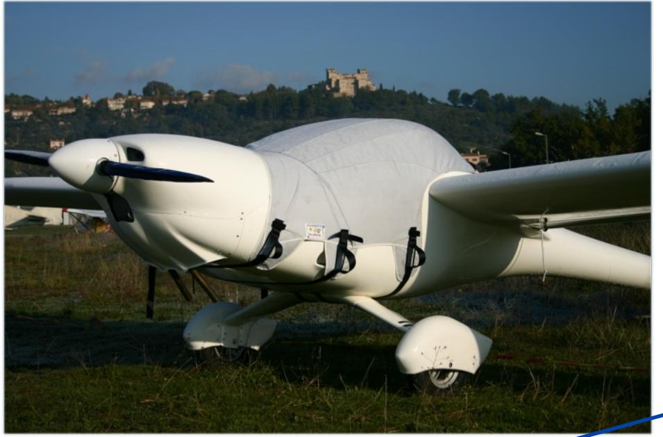
Cinq fixations sont nécessaires pour poser la bâche de cellule du Lambada trois à l'avant la plaquent devant le pare brise, deux autres la maintiennent tirée vers l'arrière en se fixant sur les bord de fuite, des crochets plats muni de bavette cuir équipent ces fixations.
