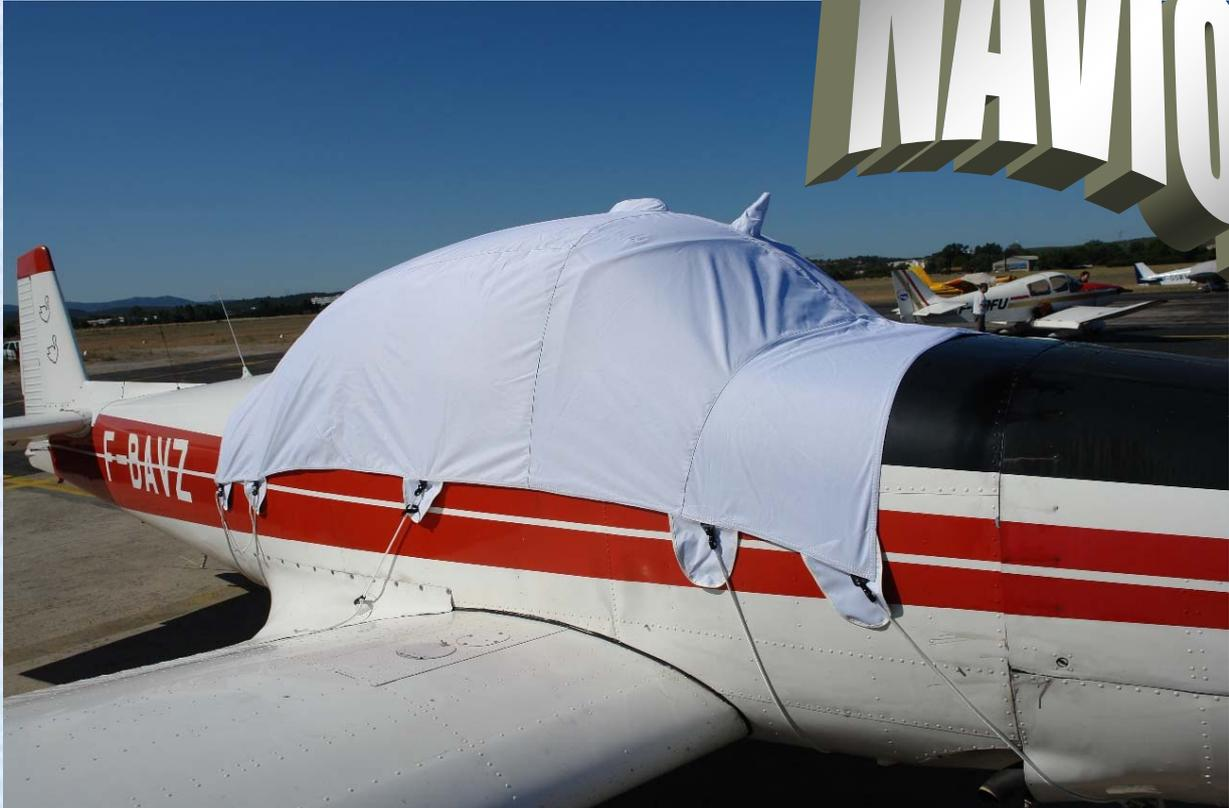
Plusieurs fixations sont nécessaires pour poser la bâche du Navion, une passe devant le train et la tire devant, une à la chute du pare-brise la maintient sur le capot, deux derrière la maintiennent sur la cellule tirée vers l'arrière, puis une de chaque côté viennent se prendre sur l'aération située sur le karman.
