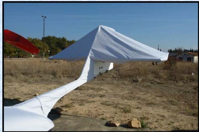
La housse de poutre et de dérive se prend sur le velcro de la housse de cellule, se déroule jusque sur le sommet de la dérive et se déploie sur les profondeurs, des sandows et crochets plastiques maintiennent la housse en place, des velcros assurent le maintien le long de la poutre.
