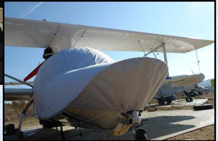
Facile a poser la housse du Petrel couvre toute la cellule, du nez de l'appareil jusqu'à la limite avant de la poutre. Trois fixations devant passent sous la cellule plus une petite devant pour la bloquer au train avant, deux à l'arrière également passent sous la cellule et une autre petite se fixe au gouvernail.
