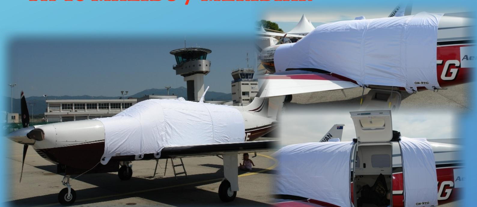
Six fixations sont nécessaires pour poser la bâche de cellule du «Malibu» trois à l'avant la plaquent devant le pare brise, trois autres la maintiennent tirée vers l'arrière.
