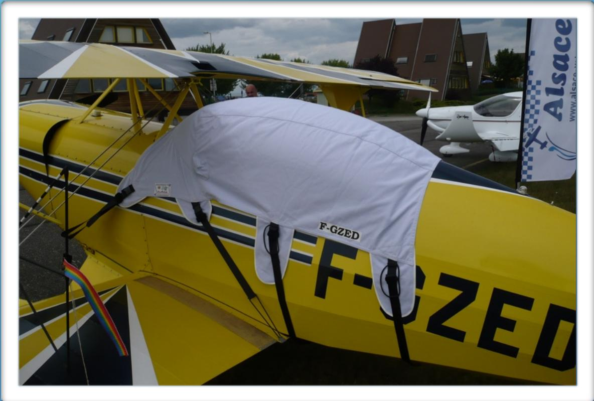
Quatre fixations par cotés sont nécessaires pour poser la bâche du Pitts, deux à l'avant la plaquent devant le pare brise, et deux autres la maintiennent tirée vers l'arrière, ainsi moulée le vent ne peut s'engouffrer et faire danser la toile, les bonnets qui recouvrent les Mano permettent un ajustage parfait.
