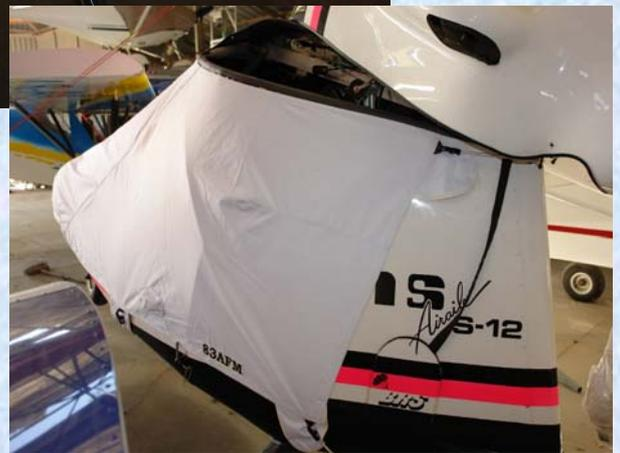
Facile a poser, trois fixations sont nécessaires, deux passent sous la cellule, et une sur la partie supérieure sous l'aile contourne la cellule, un velcro en dessous permet de refermer la toile après le train avant. Toute la verrière est ainsi protégée, la housse peut s'employer lorsque les ailes sont enlevées.
