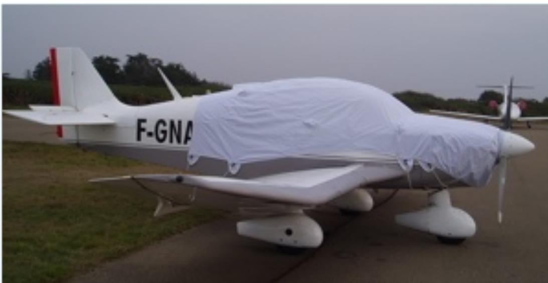
Quatre fixations sont nécessaires pour poser la bâche de cellule du «DR 253» deux a l'avant la plaquent devant le pare brise, deux autres la maintiennent tirée vers l'arrière.
