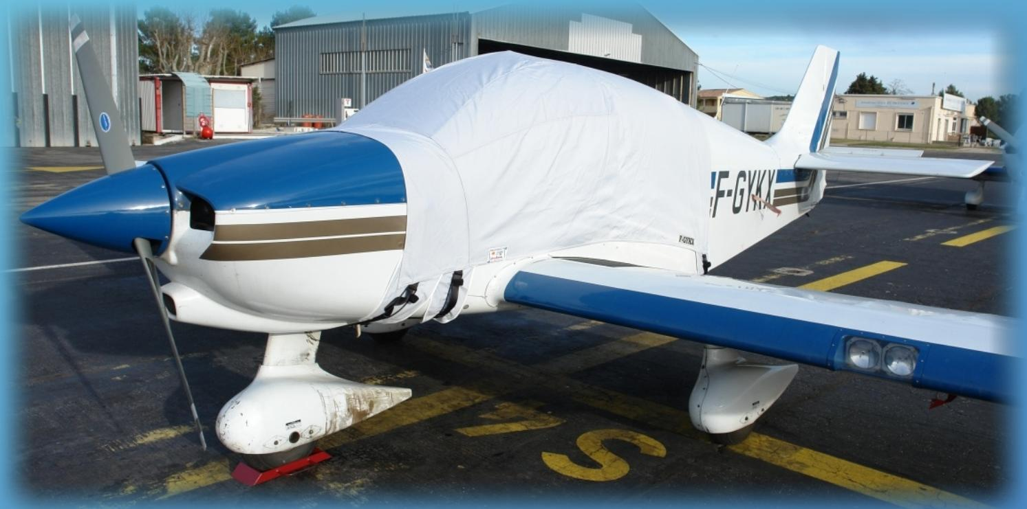
Trois fixations sont nécessaires pour poser la bâche de cellule du «Dauphin» deux à l'avant la plaquent devant le pare brise, une autre la maintient tirée vers l'arrière.
