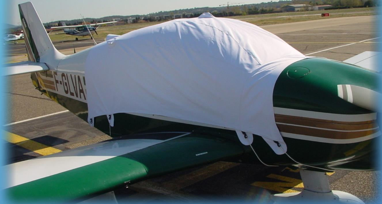
Quatre fixations sont nécessaires pour poser la bâche de cellule du «Regent» deux à l'avant la plaquent devant le pare brise, deux autres la maintiennent tirée vers l'arrière.
