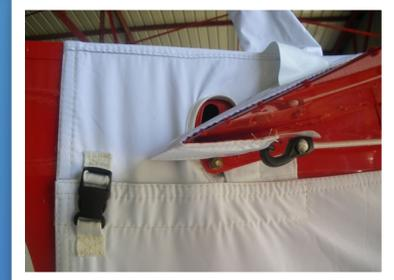
Six fixations sont nécessaires pour poser la bâche du Savannah, deux à l'avant la plaquent devant le pare brise, deux autres la maintiennent tirée vers l'arrière, et deux partent des bords d'attaques jusqu'aux bords de fuites, maintenant la partie supérieure de la cellule avec les départs d'ailes en place.
