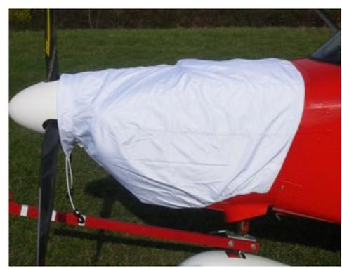
Vendue en option la bâche capot moteur se pose grâce à ses trois Velcro sur la partie avant et se referme dessous par un autre Velcro et deux boucles à clips, un fourreau contourne le cône d'hélice avec un Sandow et deux crochets plastiques, ainsi couvert l'avant de la cellule est hors d'eau et poussière jusqu'à la base du cône, d'autres éléments amovibles peuvent s'ajouter pour couvrir l'avion entièrement.
