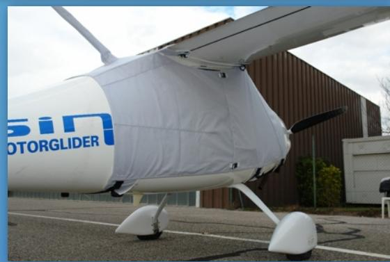
Cinq fixations sont nécessaires pour poser la bâche de cellule du Sinus deux a l'avant la plaquent devant le pare brise, une autre la maintient tirée vers l'arrière, et deux partent des bords d'attaques jusqu'aux bords de fuites, maintenant la partie supérieure de la cellule avec les départs d'ailes en place.
