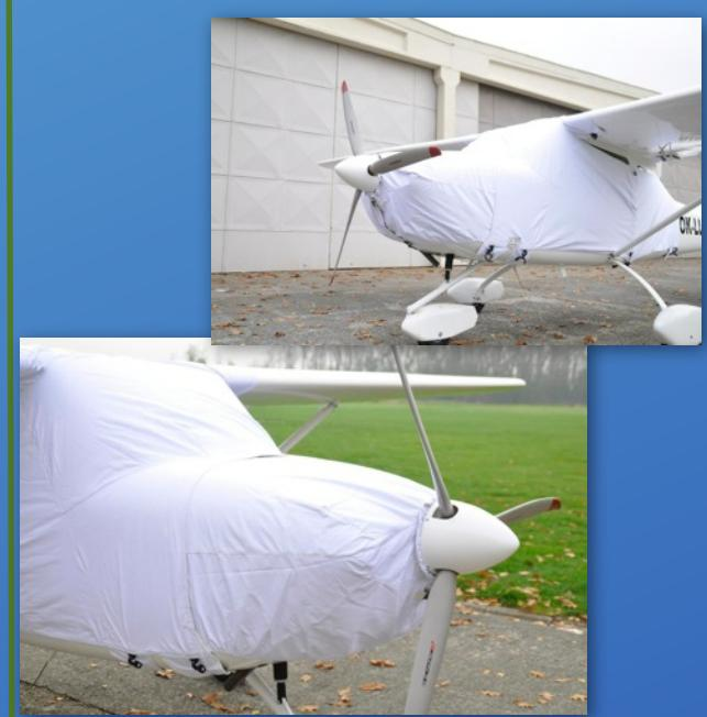
Sie bemerken sicherlich den kleinen Latz, der eigens dafür vorgesehen ist, jedes Wasserrinnsal der Dachpartie von den lateralen Teilen der Abdeckung abzuleiten.
