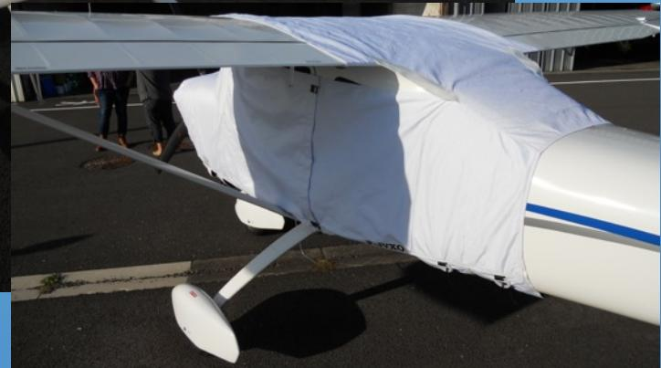
Six fixations sont nécessaires pour poser la bâche de cellule du Skylane deux a l'avant la plaquent devant le pare brise, deux autres la maintiennent tirée vers l'arrière, et deux partent des bords d'attaques jusqu'aux bords de fuites, maintenant la partie supérieure de la cellule avec les départs d'ailes en place.
