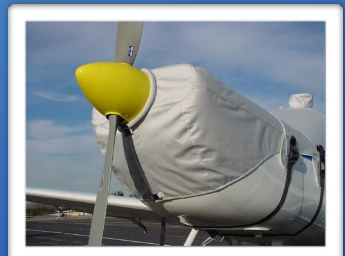
Die Motorhauben-abdeckung (separat-Verkauf) befestigt man mit seinen 3 Velcros auf der Kabinenabdeckhaube und verschliesst sie unter der Maschine mit einem Velcro-Verschluss und 2 Clipsen. Die Partie Spinner verschliesst man Dank einem Gummidurchzug und 2 Plastikhaken
