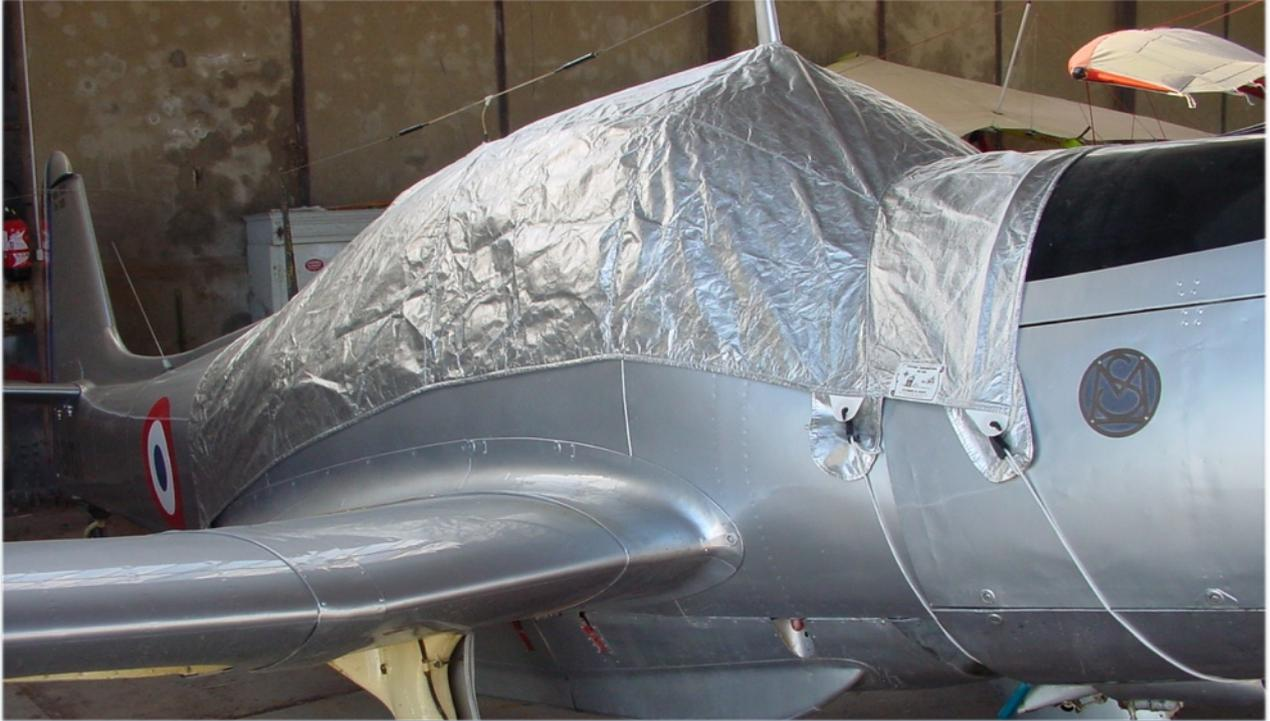
Trois fixations sont nécessaires pour poser la bâche de cellule du «MS 733» deux à l'avant la plaquent devant le pare brise, une autre la maintient tirée en arrière.
