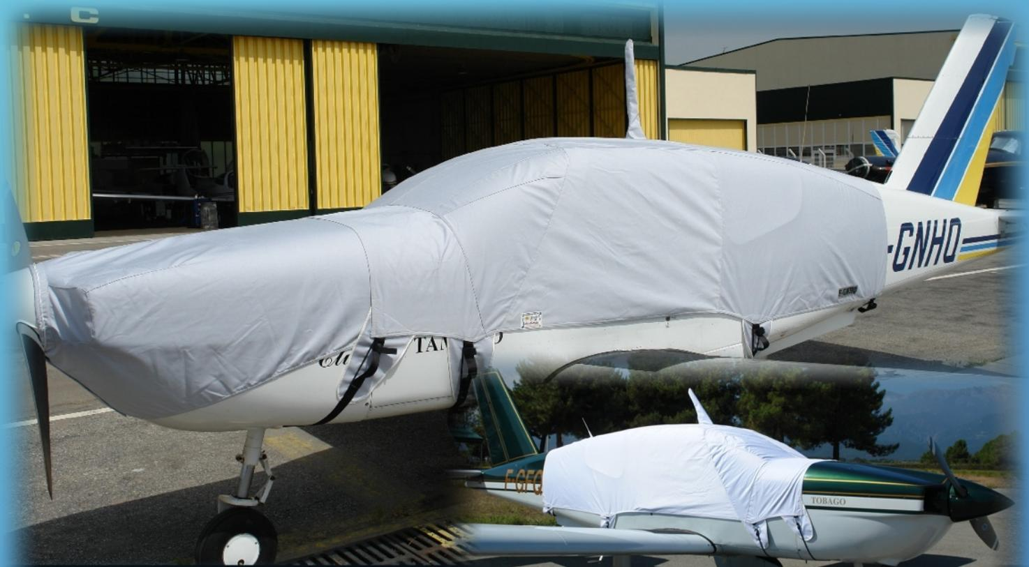
Quatre fixations sont nécessaires pour poser la bâche de cellule du «TB» deux a l'avant la plaquent devant le pare brise, deux autres la maintiennent tirée vers l'arrière.
