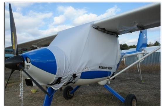
Six fixations sont nécessaires pour poser la bâche de cellule du STORCH deux à l'avant la plaquent devant le pare brise, deux autres la maintiennent tirée vers l'arrière, et deux partent des bords d'attaques jusqu'aux bords de fuites, maintenant la partie supérieure de la cellule avec les départs d'ailes en place.
