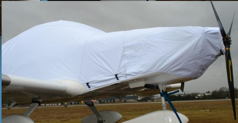
Trois fixations sont nécessaires pour poser la bâche du Storm, deux à l'avant la plaquent devant le pare brise, et une autre la maintient tirée vers l'arrière, ainsi moulée le vent ne peut s'engouffrer et faire danser la toile, les bonnets qui recouvrent les poignées permettent un ajustage parfait.
