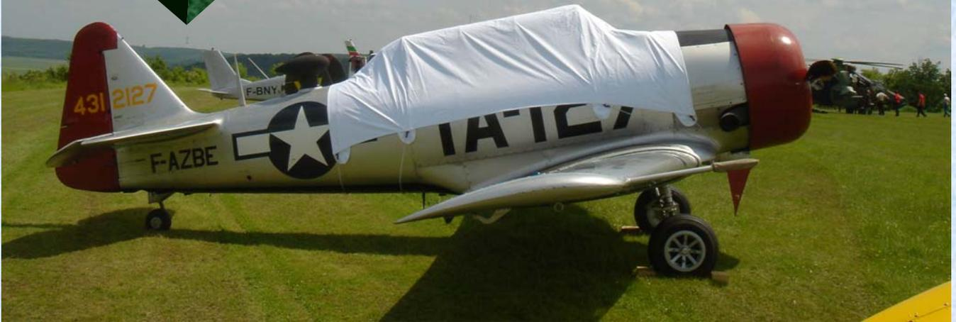
Réalisée dans le modèle Ecolight, 4 fixations suffisent pour poser la bâche T6, deux à l'avant la plaquent sur le capot moteur, et deux sur la partie arrière assurent une bonne tension évitant ainsi les risques de prises au vent.
