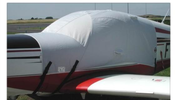
Die Motorhauben-abdeckung (separat-Verkauf) befestigt man mit seinen 3 Velcros auf der Kabinenabdeckhaube und verschliesst sie unter der Maschine mit einem Velcro-Verschluss und 2 Clipsen.
