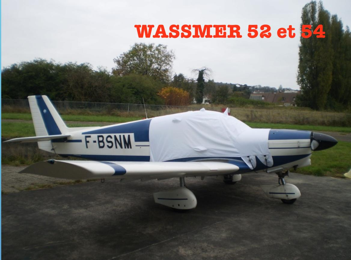
Trois fixations sont nécessaires pour poser la bâche de cellule du «WA52» deux a l'avant la plaquent devant le pare brise, une autre la maintient tirée en arrière.
