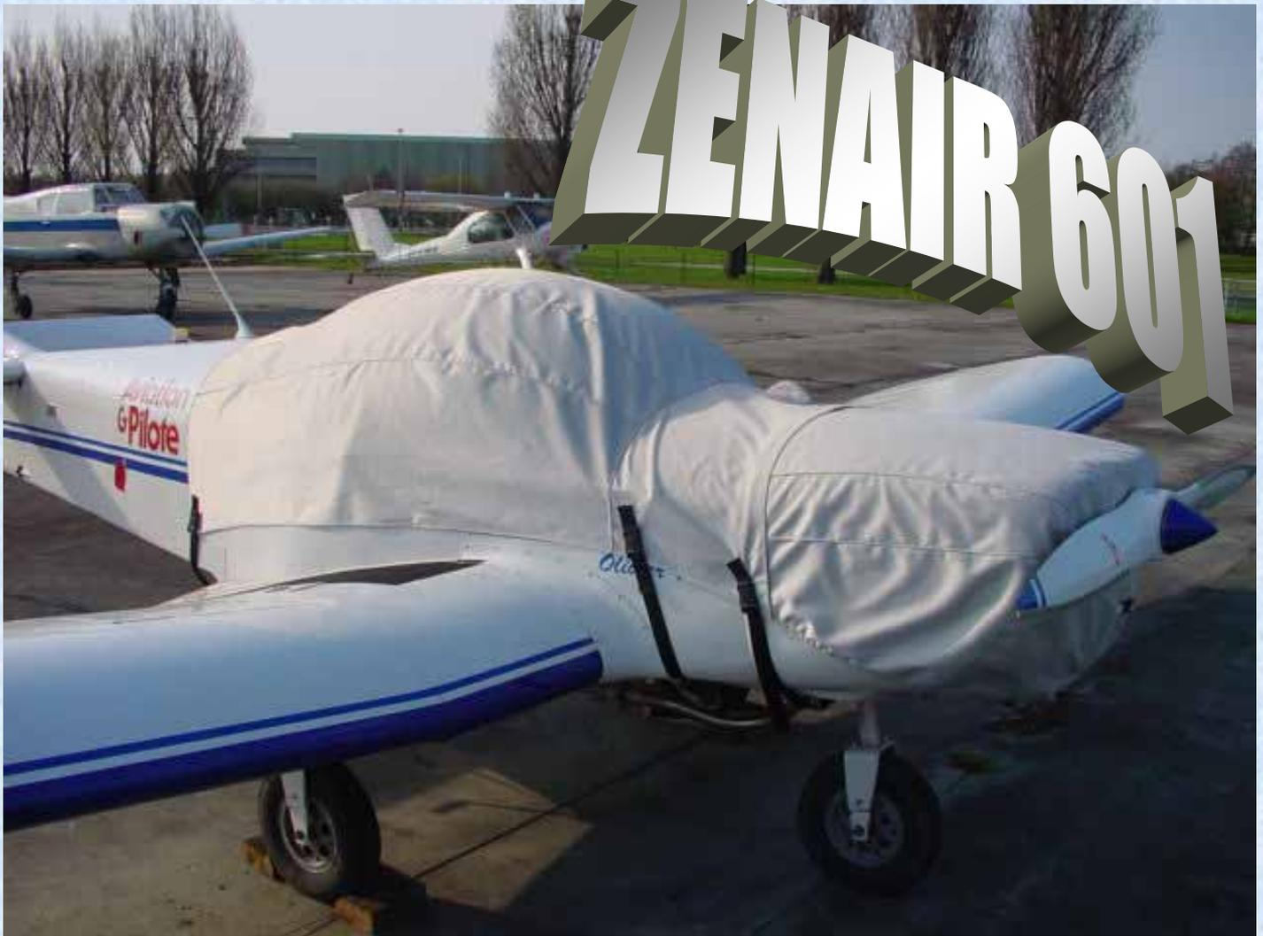
Trois fixations sont nécessaires pour poser la bâche de verrière du zodiac, deux la maintiennent plaquée sur l'avant, et une la tire et la maintient derrière.
