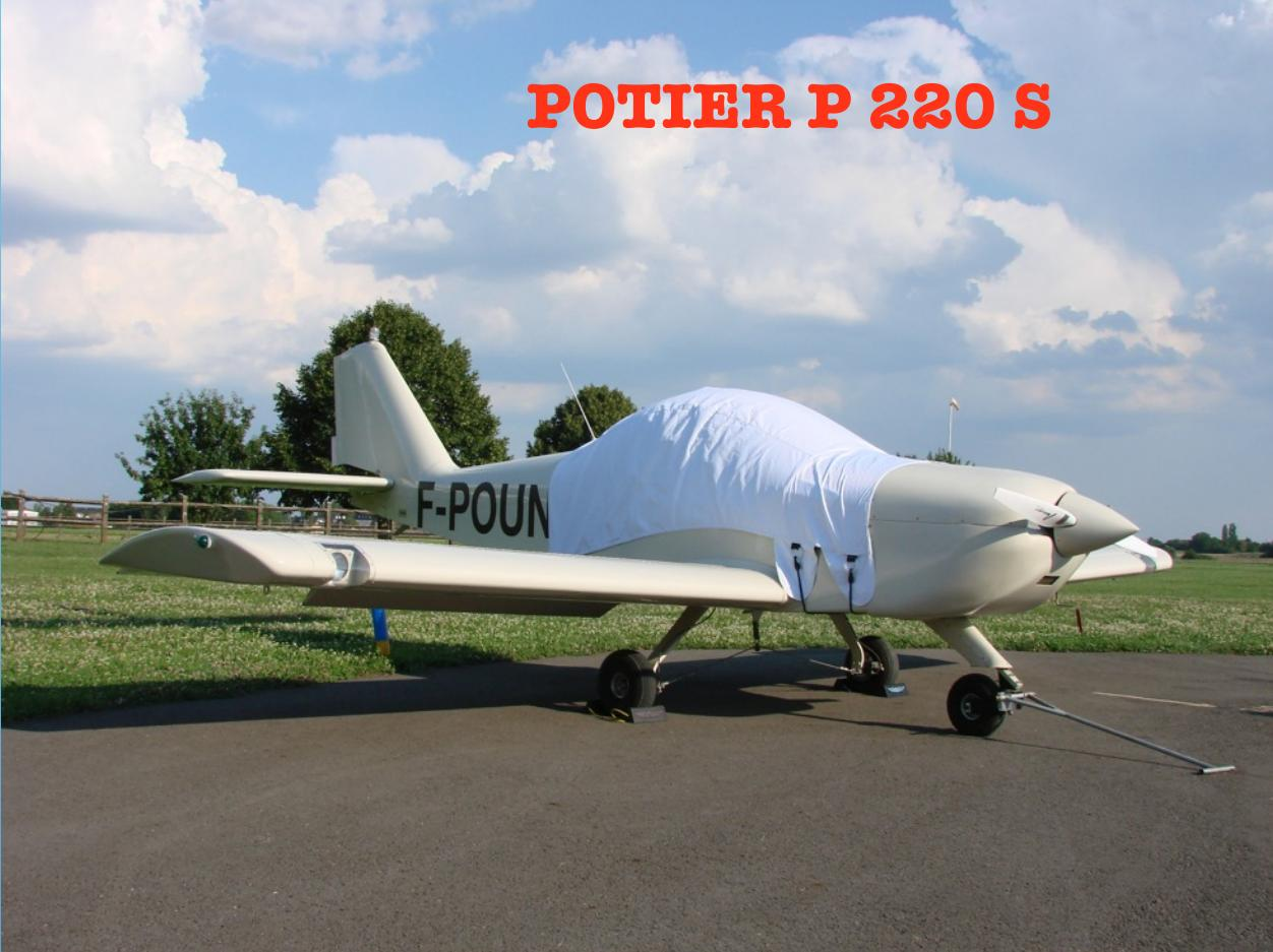
Trois fixations sont nécessaires pour poser la bâche de cellule du «P 220 S» deux a l'avant la plaquent devant le pare brise, une autre la maintient tirée en arrière.
