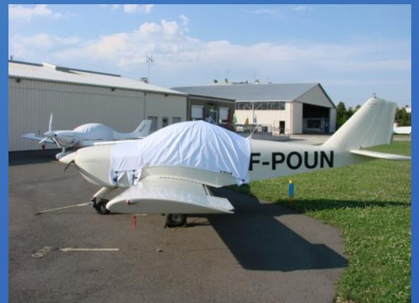
Die Motorhauben-abdeckung (separat-Verkauf) befestigt man mit seinen 3 Velcros auf der Kabinenabdeckhaube und verschliesst sie unter der Maschine mit einem Velcro-Verschluss und 2 Clipsen.
