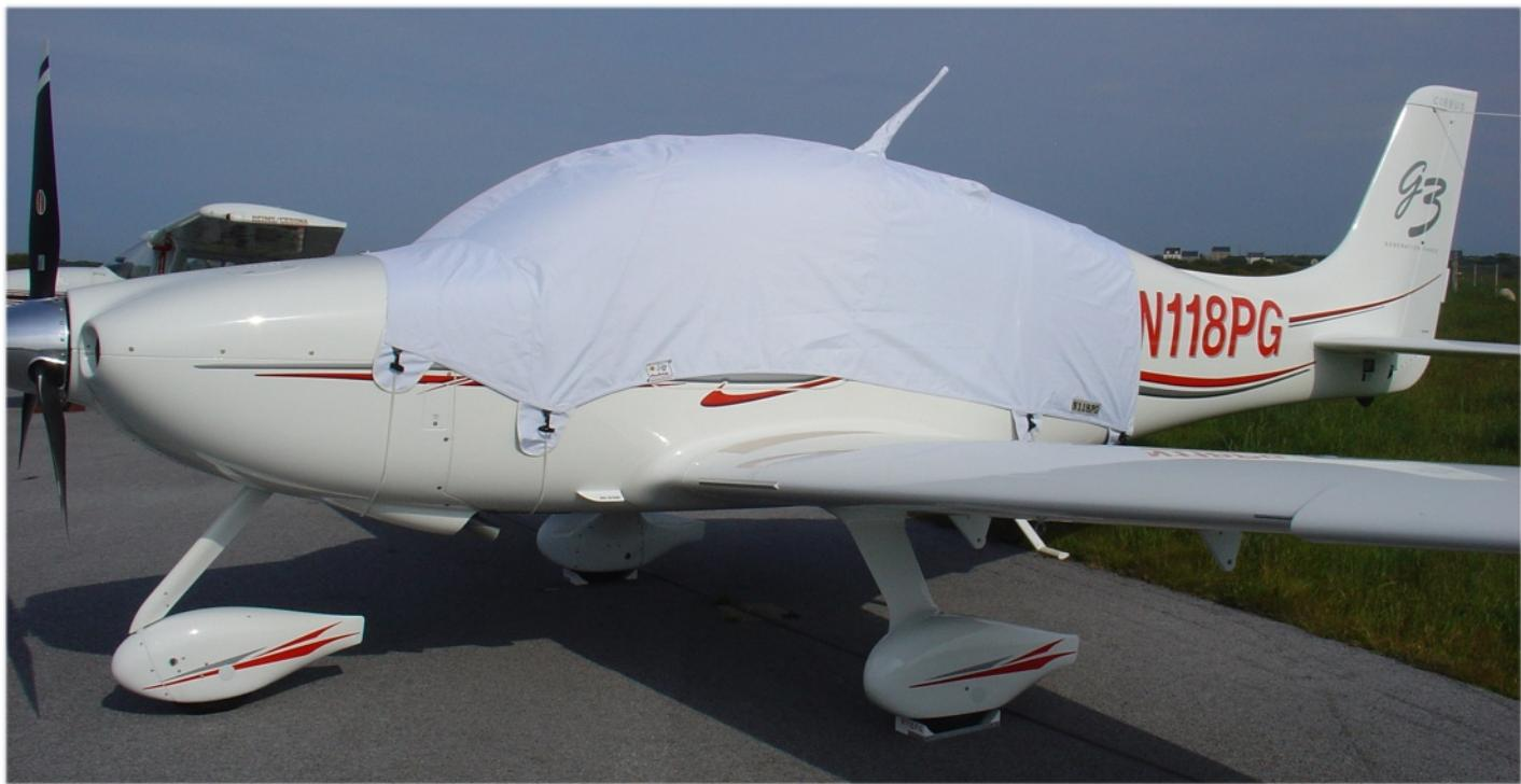
Quatre fixations sont nécessaires pour poser la bâche de cellule du «SR 22» deux a l'avant la plaquent devant le pare brise, deux autres la maintiennent tirée vers l'arrière.
