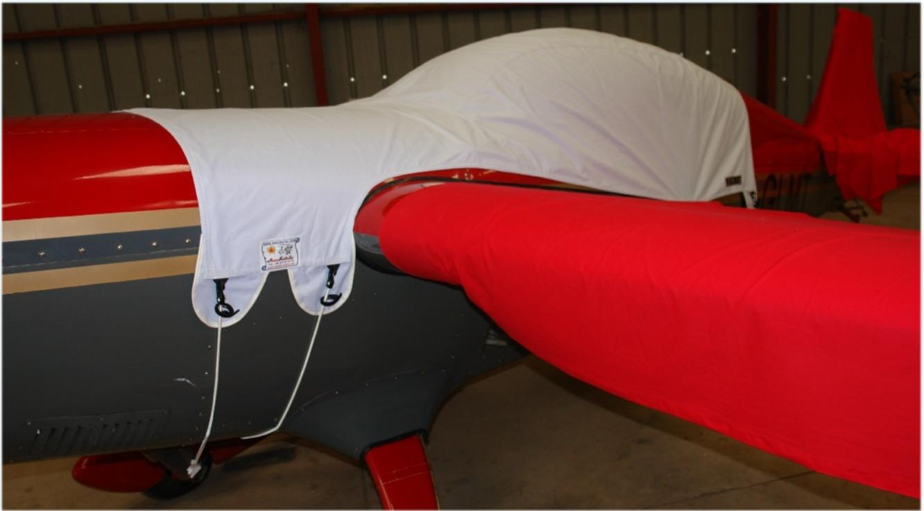
Quatre fixations sont nécessaires pour poser la bâche de cellule du «Extra 300» deux a l'avant la plaquent devant le pare brise, deux autres la maintiennent tirée vers l'arrière.
