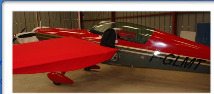
Die Motorhauben-abdeckung (separat-Verkauf) befestigt man mit seinen 3 Velcros auf der Kabinenabdeckhaube und verschliesst sie unter der Maschine mit einem Velcro-Verschluss und 2 Clipsen.
