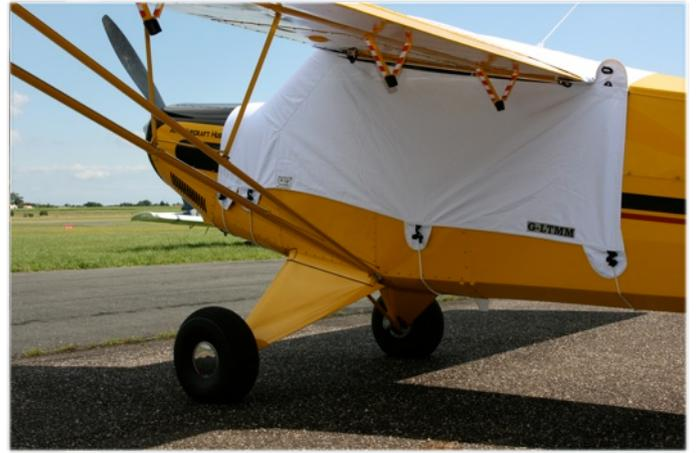
Sept fixations sont nécessaires pour poser la bâche du Husky, deux à l'avant la plaquent devant le pare brise, deux autres la maintiennent tirée vers l'arrière, et deux partent des bords d'attaches jusqu'aux bords de fuites, maintenant la partie supérieure de la cellule avec les départs d'ailes en place.
