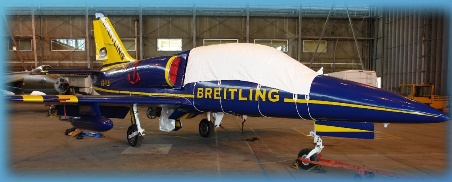
Plusieurs fixations sont nécessaires pour poser la bâche de cellule du «L 39» deux à l'avant la plaquent devant le pare brise, deux autres la maintiennent tirée vers l'arrière, une autre la maintient sur les réacteurs.
