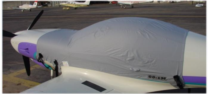
Trois fixations sont nécessaires pour poser la bâche de cellule du «Lancer» deux a l'avant la plaquent devant le pare brise, une autre la maintient tirée en arrière.
